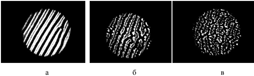
Рис.4 Трансформация полосовой структуры в лабиринтную при увеличении электрического поля: а) – U = 2,3 В, б) – U = 5,1 В, в) – U = 6,4 В.
