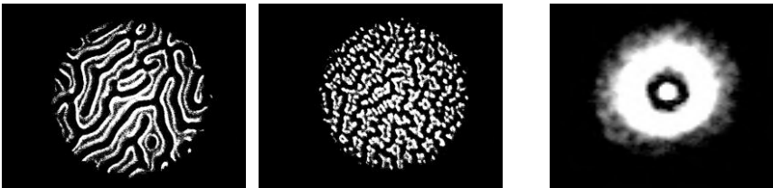
Рис. 3 Структурная решетка, образованная в электрическом поле (а), при совместном действии электрического и магнитного полей (б) и дифракция света на ней (в).
