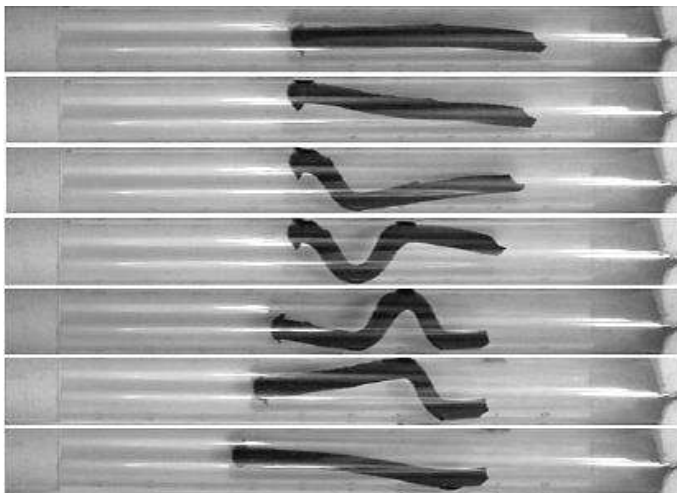
Рис. 3 (а). Движение магнитноэластичной капсулы в «бегущем» магнитном поле
