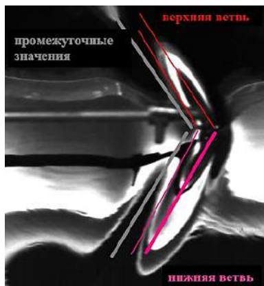
Рис. 2. Схема определения углов наклона волновых валов, возникающих на поверхности магнитной жидкости около движущегося препятствия
